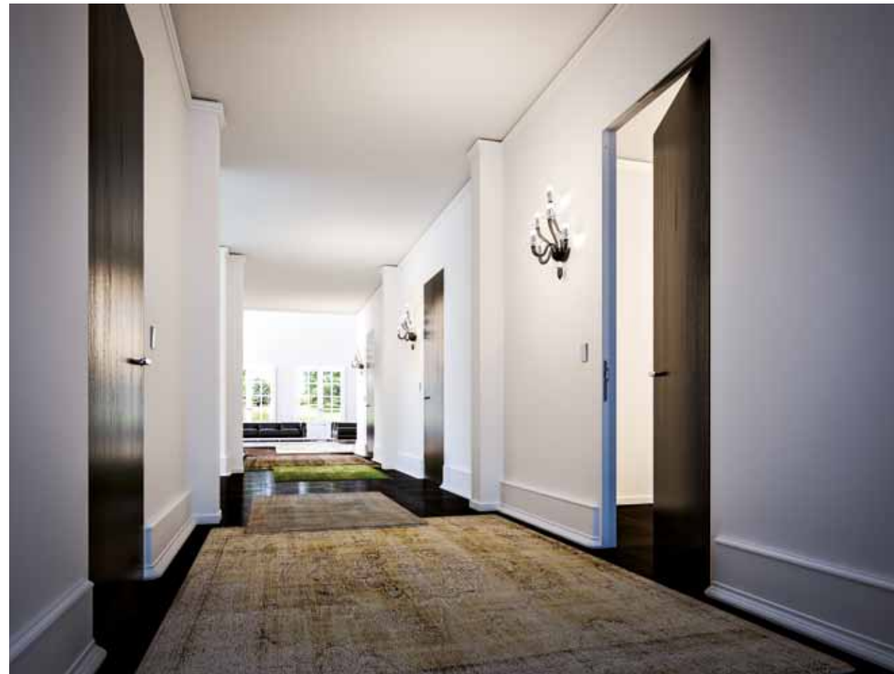
ALBA | PUERTA BATIENTE | Versión Resistente al Fuego REi 30 EI 30 | Acabado Contrachapado en madera de Roble oscuro | Cierrapuerta oculto
